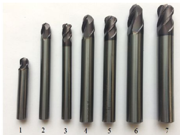
Рис. 2. Сфероцилиндрические фрезы, используемые в исследованиях
