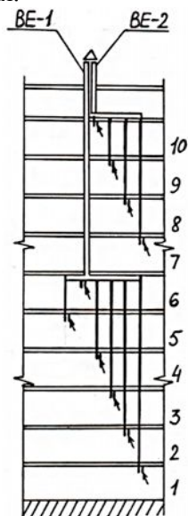
Рис. 4. Схема системы вытяжной вентиляции многоквартирного жилого дома
