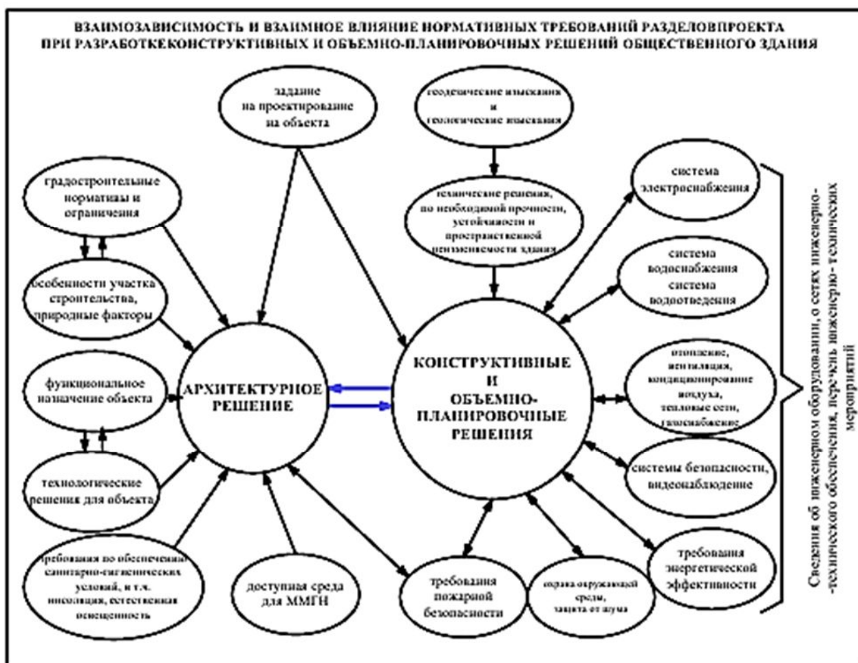
Рис. 2. Взаимосвязь нормативной базы при разработке разделов проектной документации
