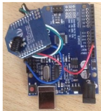
Рис. 8. Бортовое вычислительное устройство с модулем связи малоразмерного робототехнического устройства
