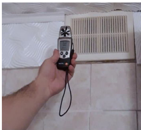
Рис. 3. Замеры скорости воздуха в помещениях квартир
